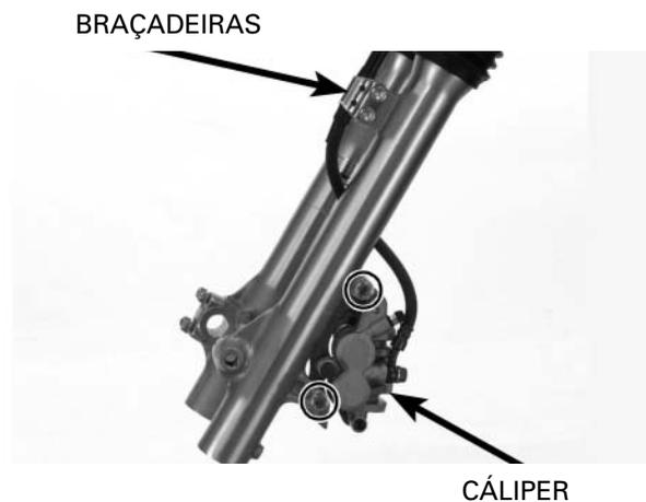
Quando o garfo da suspensão estiver pronto para ser desmontado, solte o parafuso superior do garfo da suspensão, mas sem removê-lo ainda.
