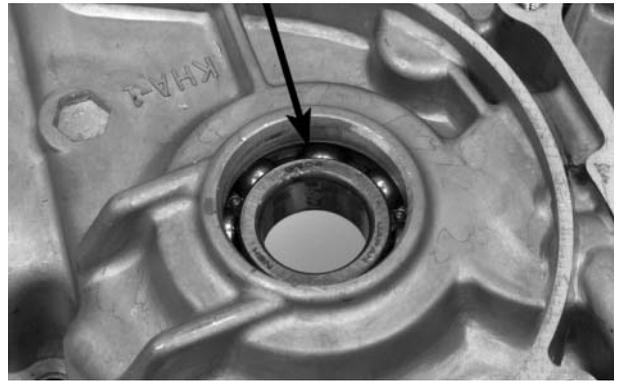
Remova o rolamento da árvore primária, utilizando as ferramentas especiais.
