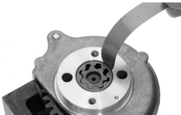
Meça a folga entre o rotor externo e a face da carcaça da bomba, utilizando uma régua de precisão e um calibre de lâmina.
