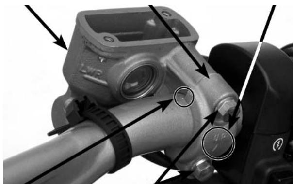
Acomode a conexão da mangueira do freio entre os limitadores no cilindro-mestre.
