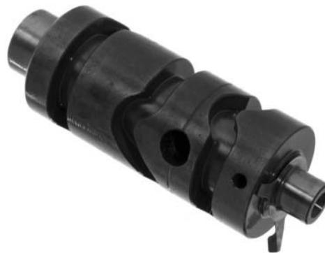
Inspeção o eixo do garfo seletor quanto a desgaste anormal ou danos.
