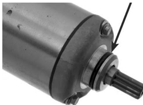
PLACAS DE FIXAÇÃO, ANÉIS DE VEDAÇÃO
