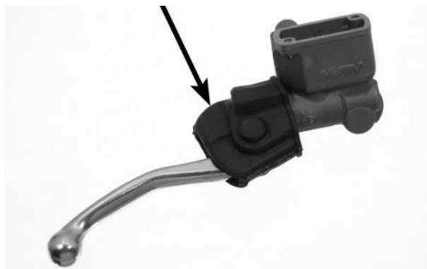
Instale o cilindro-mestre e o suporte, mantendo a marca "UP" voltada para cima.
