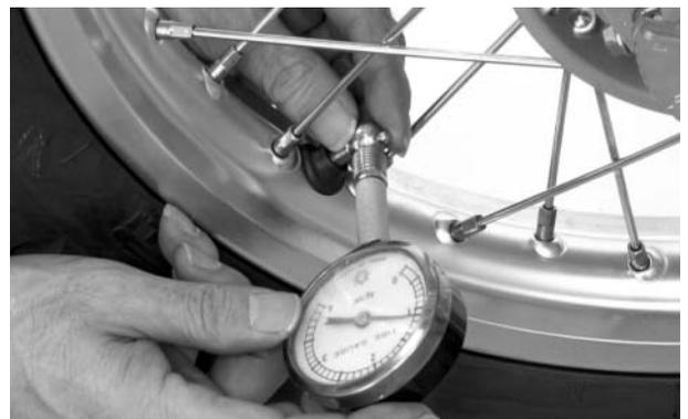
Inspeccione o aro e os raios da roda quanto a danos.
