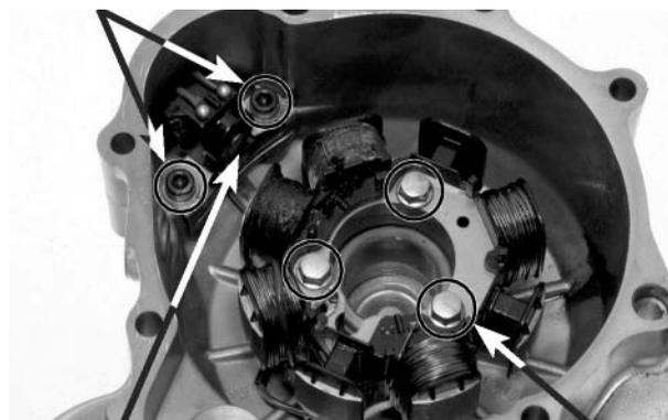
GERADOR DE PULSOS DE IGNIÇÃO
