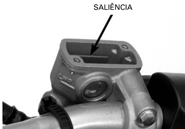
Instale o diafragma e a tampa do reservatório. Em seguida, aperte os parafusos no torque especificado.
