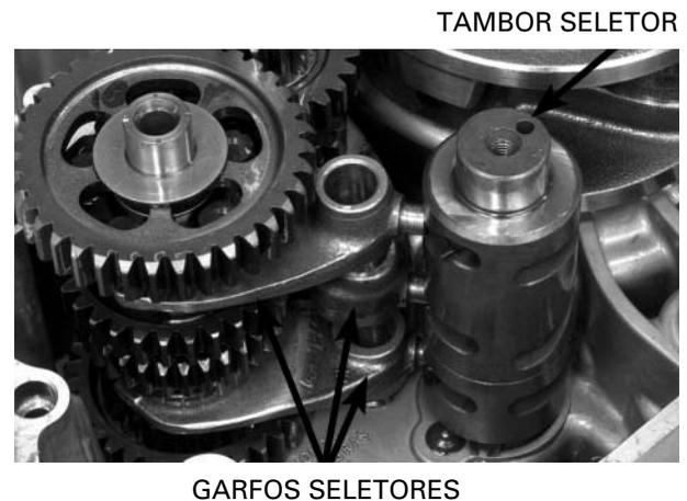
Instale o eixo do garfo seletor através dos garfos seletores e da carcaça inferior do motor.
