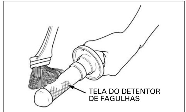
Instale o detentor de fagulhas juntamente com uma nova junta, e aperte os parafusos no torque especificado.
