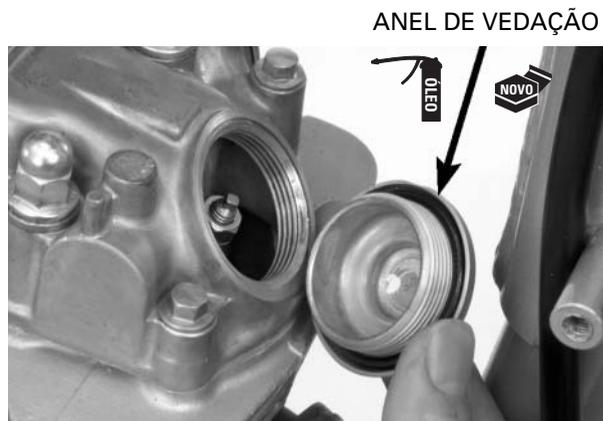
Cubra os novos anéis de vedação com óleo para motor e instale-os nas ranhuras da tampa do orifício.
