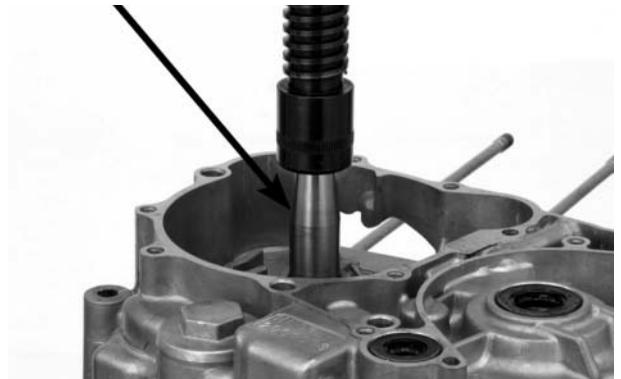
Remova o rolamento esquerdo da árvore de manivelas, utilizando a ferramenta especial, caso ela seja removida da carcaça inferior do motor junto com a árvore de manivelas. Descarte o rolamento.
