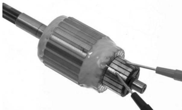
Inspecione a continuidade entre cada barra comutadora e o eixo do induzido.
