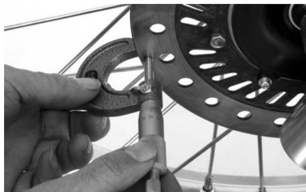
Inspeccione o disco de freio quanto a empenamento.
