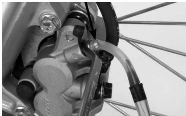
Após sangrar completamente o sistema, aperte a válvula de sangria no torque especificado.
