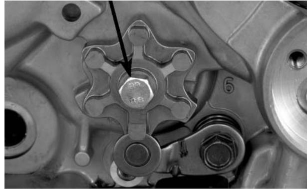
Instale a arruela de encosto no eixo seletor de marchas e insira o eixo na carcaça inferior do motor, enquanto alinha as extremidades da mola de retorno com o rebaixo.
